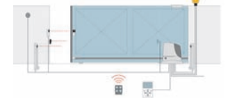
Detalle del automatismo para puertas correderas
