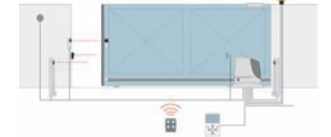
Detalle del automatismo para puertas correderas
