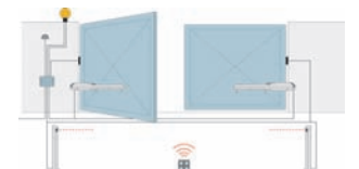
Detalle del automatismo para puertas batientes en una hoja o dos hojas
